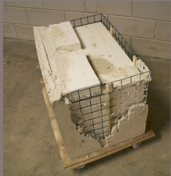
De houten bak was niet sterk genoeg en ging "bol" staan
